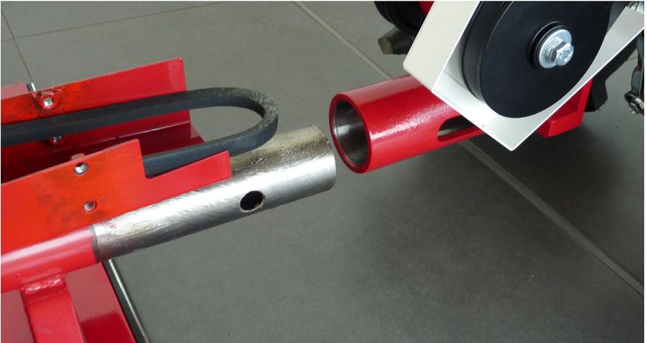
Jetzt wird das Mähwerk mit der Antriebseinheit gekoppelt.
