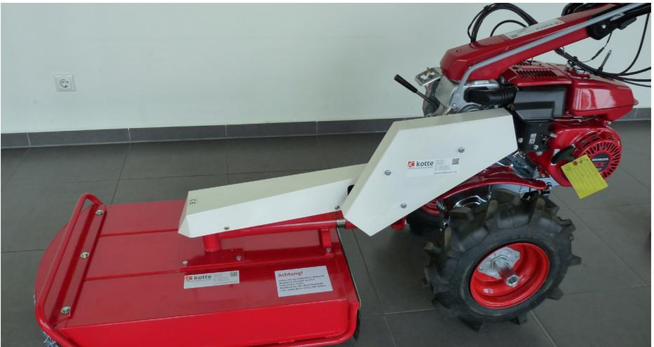
Zum Schluss müssen alle Schutzabdeckungen montiert werden.
