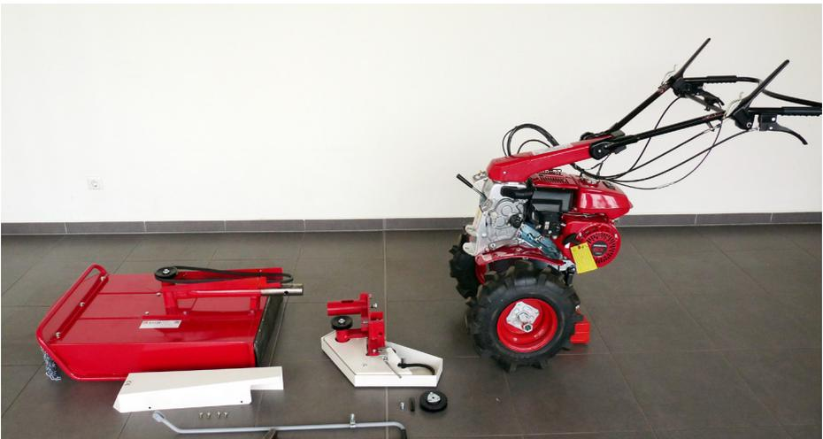
Die Bedieneinheiten des Einachsschleppers müssen um 180° gedreht werden. Dazu muß der komplette Holm von der Maschine gelöst, gedreht und wieder fest montiert werden.
