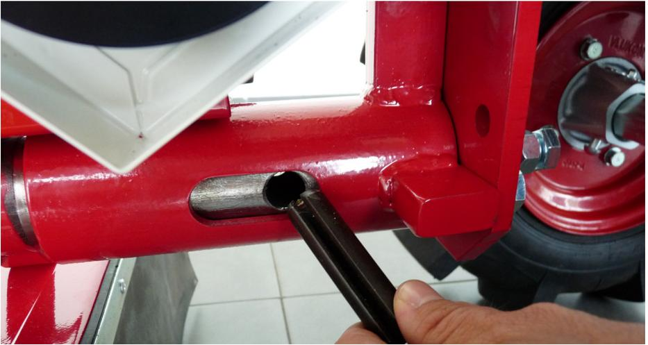
Das Mähwerk wird nun gegen ein Herausrutschen mit einem Federstift gesichert.
