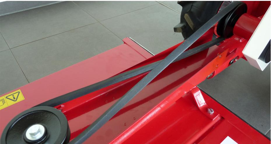
Nun wird der Keilriemen in einem Winkel von 90° auf die Antriebs-Keilriemenscheibe gelegt.
