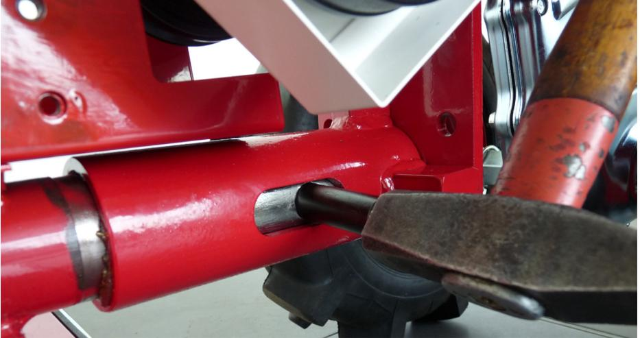
Den Federstift mit einem Hammer in die vorgesehene Bohrungs schlagen.
